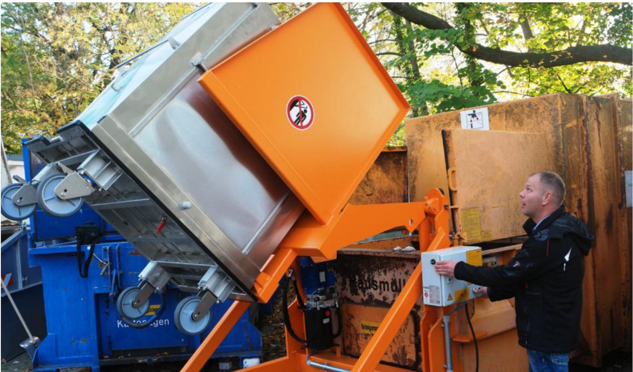
Herzstück des neuen Abfallsystems: die automatische Kippvorrichtung. Zuvor mussten die Müllsäcke einzeln per Hand in den Sammelcontainer gewuchtet werden.
