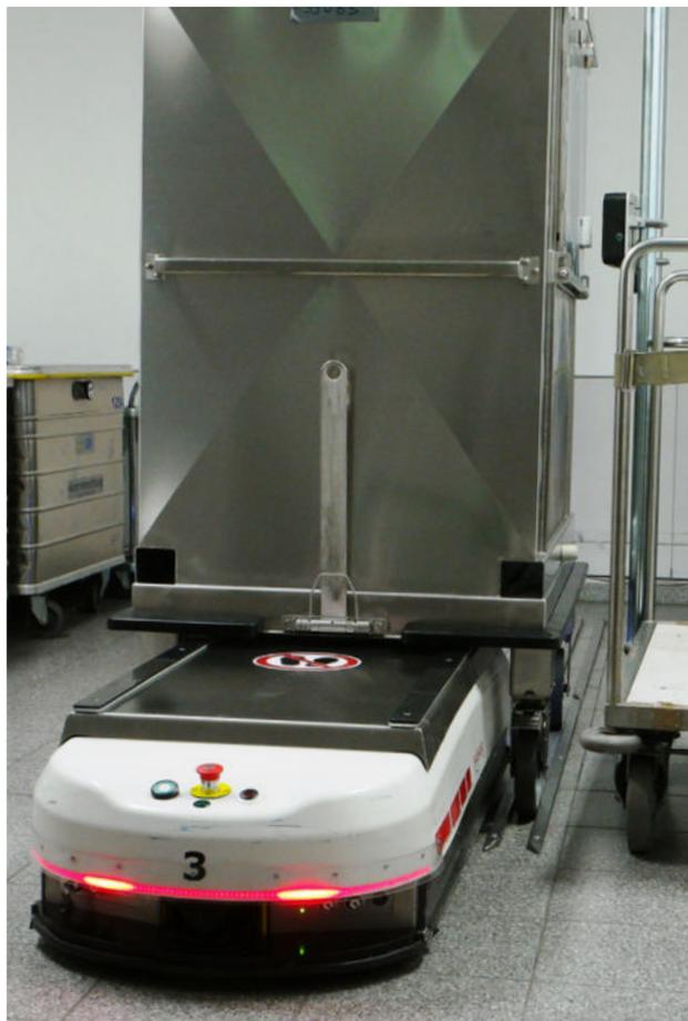
Hochzeit: Hier bockt das Fahrzeug den Container auf, indem er ihn punktgenau untertunnelt und anhebt – alles ohne helfende Hände.
